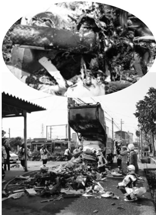
破砕ごみの中に、中身の入っているカセットボンベ、スプレー缶やガスライターが入っていることが原因で、ごみ収集車で火災が発生しています。
