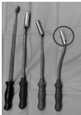
▲馬の歯に使う手動のヤスリ。 丸囲み部分に金属製のヤスリ（右）がついている
