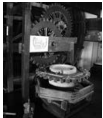
西みせには直径4メートルに及ぶ大きな車輪の木製動輪製薬機
