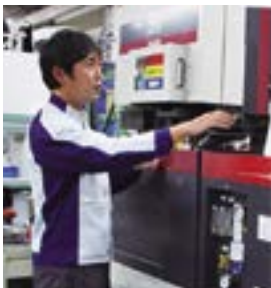
▲ワイヤに電流を流し、放電現象を発生させ金属をカットします。プログラムを設計し、ミクロン（1000分の1）単位の高精度で加工。熟練した技と知識が求められます
