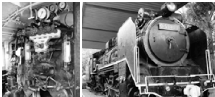
操作用のハンドルやメーター昭和48年に廃車となるまで34年間草津線などが当時のまま残る「デゴイチ」200万キロ以上も走り抜けたD51型403号機の運転室
