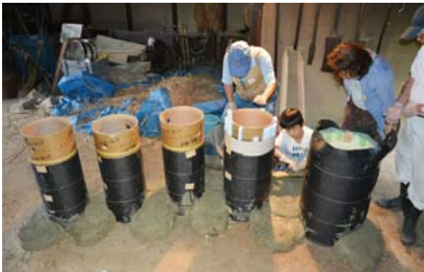
29 土積み上げ 中型に合せて積み上げ、団子どうしをなじませる (2015.07.04 ワークショップ4日目 土積み上げ)
