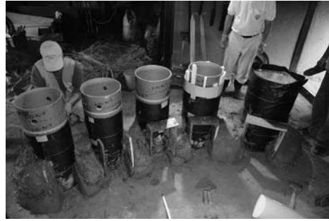
図29 瓦を鳥居に組んで焚口を成型
