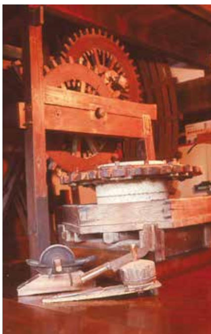
写真 2-19 大角家（旧和中散本舗）製薬機械
