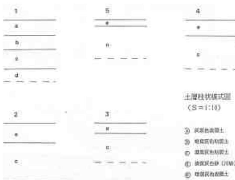
〔図 3-29〕 土層柱状模式図（1：25）
